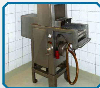
Mașina de injectat cu 15 ace RÜHLE Ptr injectarea cârnii de porc fără os.
