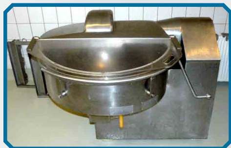
Cutter 60 litri SEYDELMANN Inoxidabil în totalitate 3 cuțite de tăiere 2 viteze de tăiere 1 viteză de amestecare
